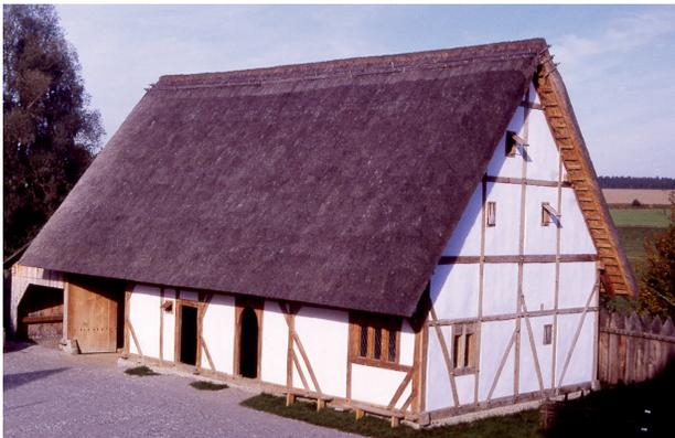
Bild 2 Das Bauernhaus ist eine nachgebaute spätmittelalterliche Hauskonstruktion, die den im Neckarland, im Kraichgau und am Oberrhein vorhandenen so genannten Firstständerbauten folgt.
